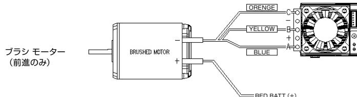
■スピードコントローラーとモーターの配線は必ず確認してください。スピードコントローラーが破損する原因となります。取り付け、および取り外しの場合は気を付けて作業を行ってください。
