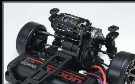
加速時にリヤトラクションが高まる4ギヤトランスミッションの新型ギヤケース。密閉式で防塵性も高くなっています
