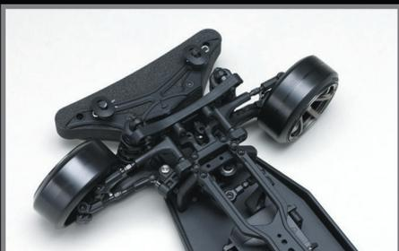
従来に比べてさらに切れ角を上げ、ドリフトアングルのコントロール幅を増やしてスピンを防止します
