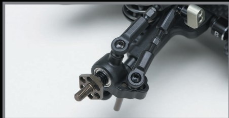
新設計のステアリングブロックを採用し、レスポンスと安定感を高めたアッカーマン比設定
