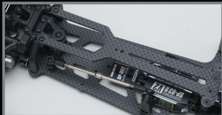
後ろ寄りのサーボ搭載により前後の重量配分を3:7に設定でき、RWDドリフトの理想的なバランスとした
