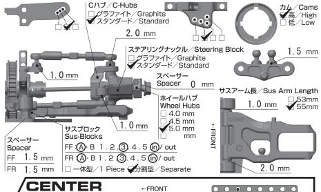
車高 Ride Height 4.3 mm キャンバー Camber Angle 1.0 スタビ/Sway Bar 1.2 (1.3)1.4 mm ドループ/Droop サスアーム外下/Arm 5.0 mm
