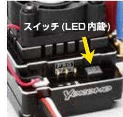
A) ESC の電源を切り、送信機の電源を入れます。スロットルチャンネルを "REV"、スロットルトリムを "0"、スロットル値を "EPA/ATV"、ブレーキチャンネルを "100%" に設定し、送信機の ABS 機能を無効にしてください。
