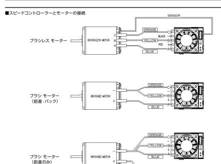
■スピードコントローラーとモーターの配線は必ず確認してください。スピードコントローラーが破損する原因となります。取り付け、および取り外しの場合は気を付けて作業を行ってください。
