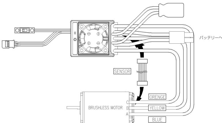
※必ずセンサーケーブルを接続して下さい。
