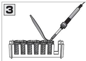
バッテリーバーの両端にペーストを塗り、図の位置に置き、動かないように上から押さえつけます。ハンダこてにハンダを少量付けて溶着します。
