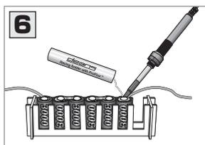
使用用途に合わせ、別売のシリコンワイヤなどを両端のセルに溶着します。
