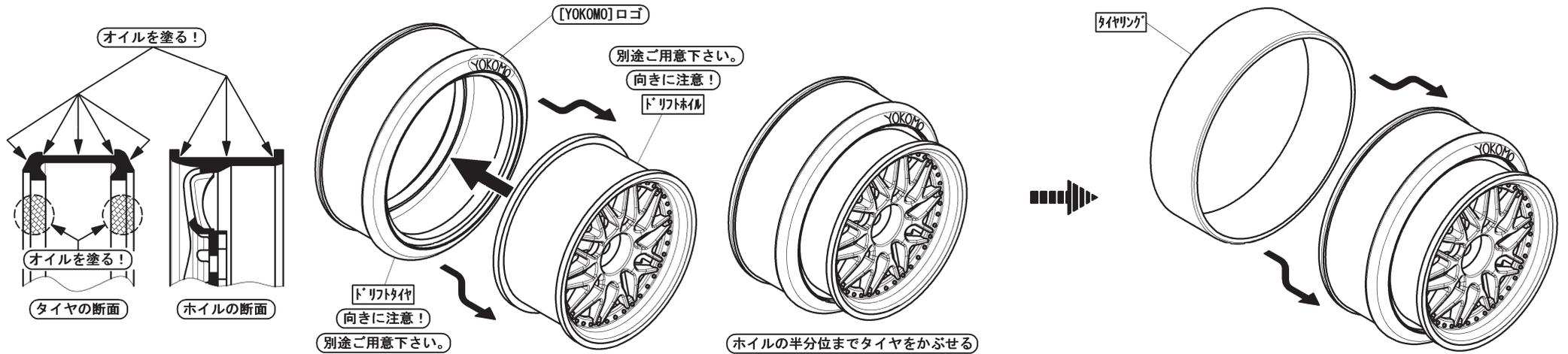
ティッシュペーパーにCRC等の潤滑オイルを吹きつけ(ご家庭にあるサラダオイル等を使用するのもOK)、左イラストのように、タイヤのトレッド面全周、タイヤ内側の両リブ全周、両サイドのクボミ全周、ホイールのリム幅面全周にタップリと塗りつけて下さい。ホイールスポーク部とタイヤ[YOKOMO]ロゴの向きを確認し、右イラストのようにホイールの半分位までタイヤをかぶせた状態にします。タイヤがはめ込みづらい時は、あらかじめお湯でタイヤをあたためておくと柔らかくなり作業がしやすくなります。
