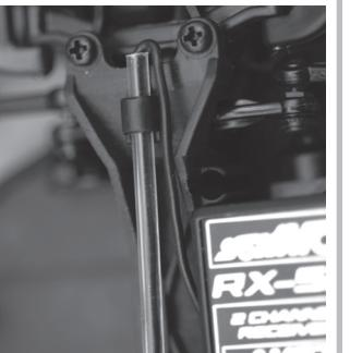
アンテナをアンテナパイプに通し、アンテナパイプを、アンテナホルダーに写真のように固定します。
