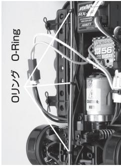
アンテナパイプより突出しているアンテナパイプは折り返して付属のOリングでアンテナパイプに留めます。アンテナはかなり長いので、シャーシに付属のOリング2個も使用しアンテナパイプに留めます。
