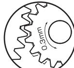
ギヤの噛み合わせは0.3mm程度ガタつくように合わせます。ガタが多すぎるとギヤが破損しやすくなるためご注意下さい。
