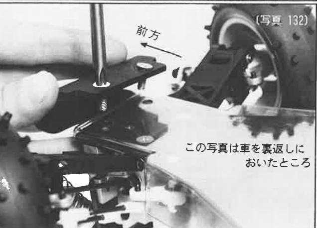
(写真 132) 写真131で出来上がったアンダーカバーをシャーシプレート下側よりかぶせるようにして取付けます。まずフロント（前）バルクヘッドの前方の仮締めておいた緑色の8-32皿ネジ2本と次頁写真133でドライバーを当てているモーターマウントを止めている一番後のM 3 トラスネジ1本の計3本を一度ゆるめて外して下さい。3本のネジを外したら、先程作っておいたアンダーカバーを左写真のようにかぶせて、ミニバンパーの穴に先に外した緑色の皿ネジを2本入れ、アンダーカバーをはさみ込むようにして、しっかりと締めてください。
