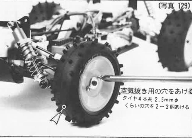
(写真 129) タイヤ付きホイルを、ホイルハブにNo.9、M 3×8mmナベ頭ネジ8本（No.9袋ホイルハブと一緒に入っていた）を使ってしっかりと取付けて下さい。
