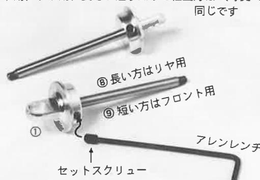
(写真 102～103) №15 ショックアブソーバ部品の袋を取り出し内容を確認して下さい。この袋には前後のショックアブソーバー各2本計4本分が入っています。非常に数が多いので、小袋ごとに良く点検する事。
