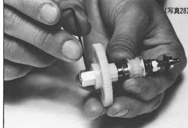
(写真26～28) メインギヤ⑩の六角穴に⑪センターダイレクトハブを写真の方向に入れる。強くいっぱいまで押し込む。メインギヤにセンターダイレクトハブが確実に入った処で、先ほど作ったセンタードライブシャフトに差込みますが、この時センターシャフトのDカット部分にダイレクトハブのセットスクリューの穴位置が合うようにして写真28のようにセットスクリューを入れ、アレンレンチ（ショックオイル、サーボ固定用テープが入っている№.0の袋のものを使用）でしっかりと締めて固定する。以上出来上がりしたら、写真29～写真30は飛ばして写真31のデフの組立に行って下さい。
