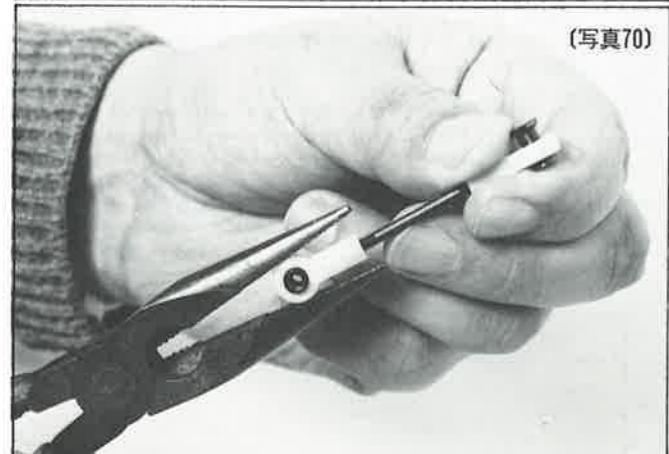
(写真70) もしも、スチールボールを入れた後、ロッドエンドボール部分の動きがしぶいようでしたら、写真のようにラジオペンチで、プラ部品を少しづつぶして下さい。いっぺんにやるとガタガタになってしまふ場合がありますので注意して下さい。とにかくガタがなく軽く動くほど良いのです。
