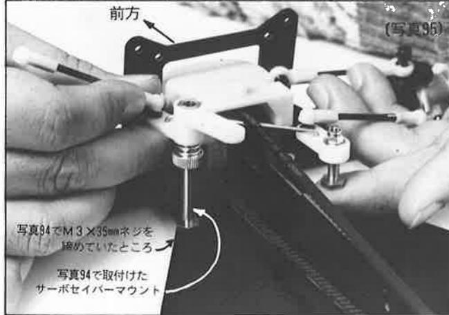
(写真95) 今、取付けたサーボセイバーマウントに、サーボセイバーを左の写真のようにして差し込みます。
