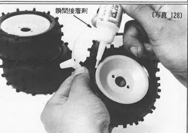
(写真 128) タイヤをホイルにはめ込む。ホイルにタイヤをはめ込んだだけでも走行はできます。しかし、レースはもちろん、性能を最大限楽しみたいという方には、必ず接着することをお勧めします。外側だけでなく内側も接着します。また、タイヤの外周面には、空気抜き用の2.5mm位の穴（次頁の写真129 参照）を2~3コあけるようにしてやると更に好結果が得られます。
