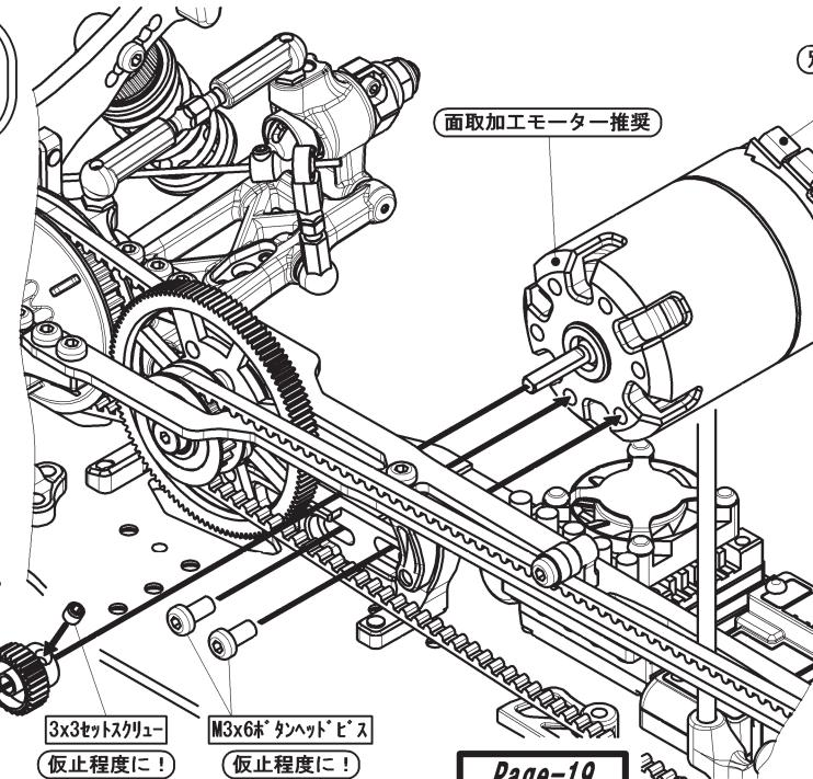
スパーギヤの歯幅にかみ合うようにピニオンギヤの位置を調整し、セットスクリューを本締めします。
