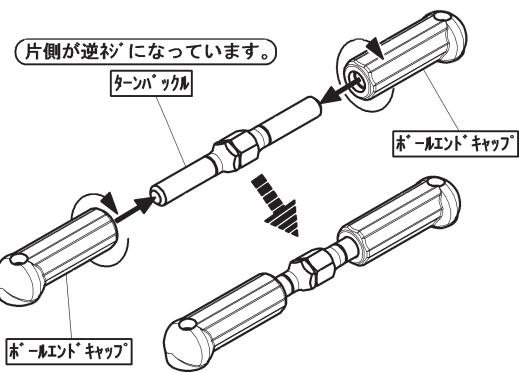
各ターンパックルの両側からボールエンドキャップをねじ込みロッドを組立てます。
