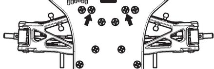
ササアーム取付け後、アームの作動が渋い場合は、サスマウント取付ビスの締め込み過ぎによるササアームピンの歪みが原因です。イラストで示すビス(2本)を一度ゆるめ、アームの作動を確認しながら締め直して下さい。あまり変化が見られないようでしたらこのビスを取り外して下さい。(ビスを取り外しても走行上の問題はありません。フロント側も同様に調整して下さい。)
