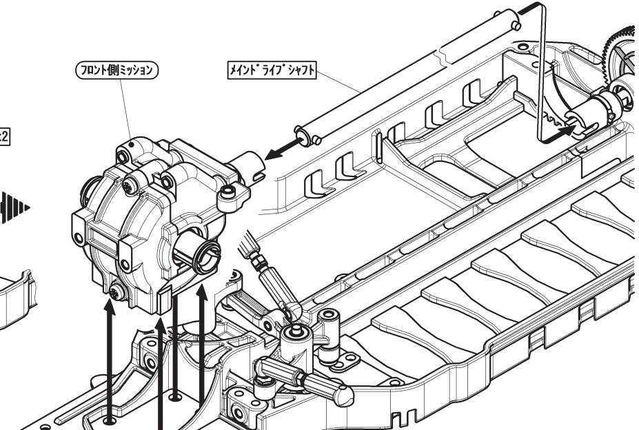
(メインドライブシャフト)を前後ドライブカップに通し、フロントミッションを(M3×10皿タッピングビス)で固定します。
