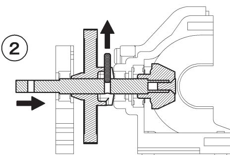
スパーギヤのミゾからハブピンが見える位置までリヤインプットシャフトをズラしハブピンを抜く。
