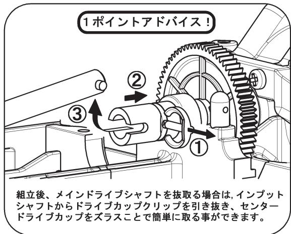
組立後、メインドライブシャフトを抜取る場合は、インプットシャフトからドライブカップクリップを引き抜き、センター ドライブカップをズラスことで簡単に取ることができます。
