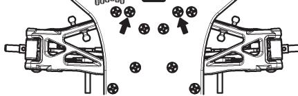
サスアーム取付け後、アームの作動が渋い場合は、サスマウント取付ビスのしめ込み過ぎによるサスアームピンの歪みが原因です。イラストで示すビス(2本)を一度ゆるめ、アームの作動を確認しながらしめ直して下さい。あまり変化が見られないようでしたらこのビスを取り外して下さい。(ビスを取り外しても走行上の問題はありません。フロント側も同様に調整して下さい。)
