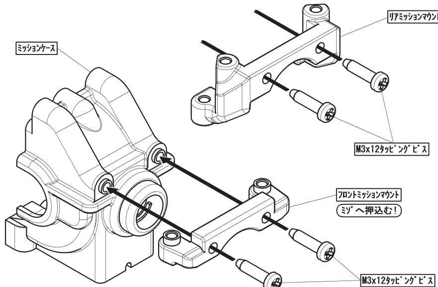
(ミッションケース)に(フロントミッションマウント)をはめ込み、(M3x12タッピングビス)で固定します。
