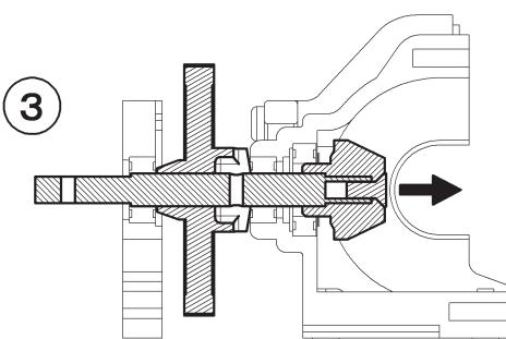
リヤインプットシャフトを完全に引き抜きスパーギヤを上から抜く。
