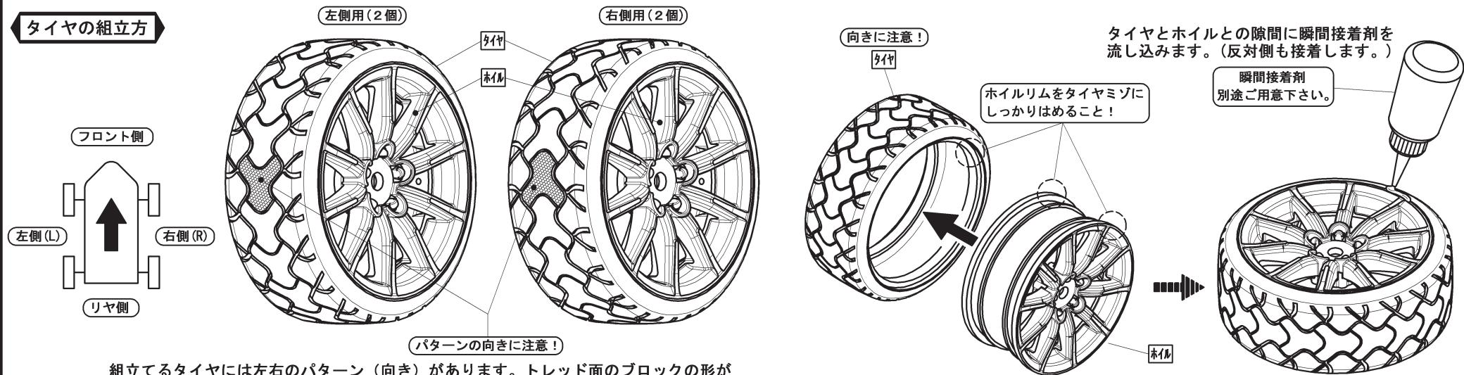
組立てるタイヤには左右のパターン（向き）があります。トレッド面のブロックの形が左側、右側でイラストと同じ向きになる様にホイルをはめ込み、接着して下さい。（それぞれ2個づつ作成します。）
