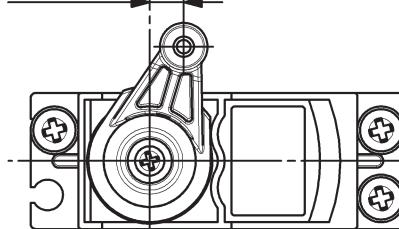
サーボのニュートラルを出した後、イラストのようにサーボホーンを1山分（約5mm）ずらして取付けて下さい。
