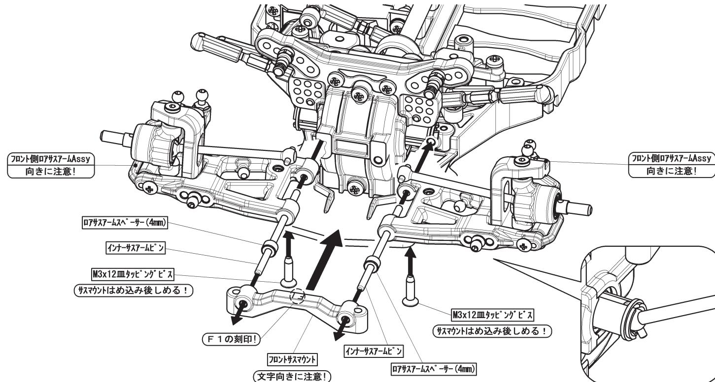
ソリッドジョイントにドッグボーンをはめた状態でサスアームピンをマウントにさしこみ固定して下さい。
