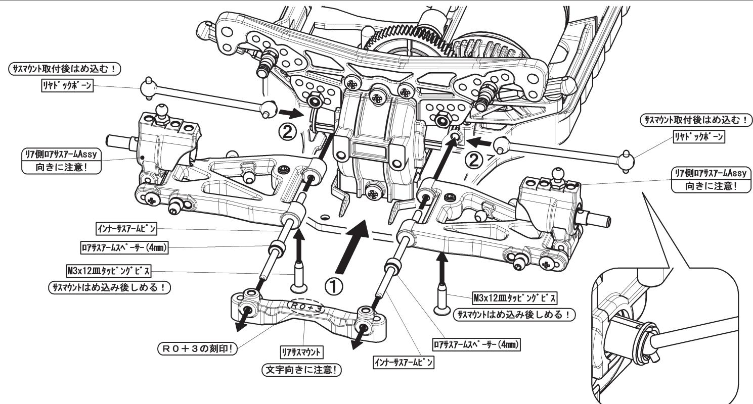
リアサスマウント取付け後、ドックボーンをソリッドジョイントにはめ込み、リアアクスルに差し込んで下さい。
