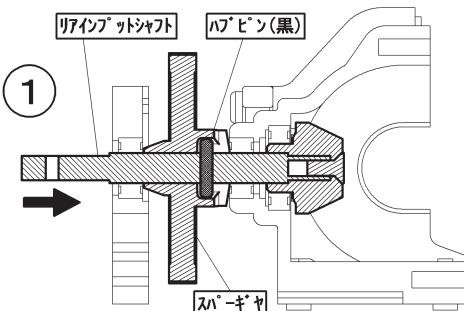
ミッショングケースキャップ、リジットジョイント、センタードライブカップを外しリヤインプットシャフトを後方へづらす。
