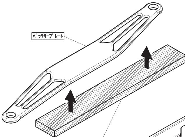
使用するバッテリーの種類によってはスキマができる場合がありますので、付属する3種類のスポンジテープを使用しガタが出ないように貼り付けて下さい。
