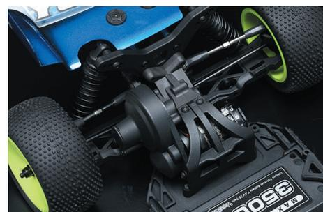
扱いやすさと高い走行性能で大人気マシンとなったROがさらに進化!ダート路面にも対応した駆動系を手に入れて、さらにリーズナブルになってリリースとなります。最も大きな変化となるのはリヤ周り。ダート路面での走行で駆動系を守るギヤカバーが装着され、砂や小石の多い路面でも気兼ねなく大胆な走行が可能です。ギヤケースもリヤトラクションを重視したギヤケースを採用し、モーター位置を後方寄りに設定することで重量物をリヤアクスルに近づけています。バッテリー位置も調整範囲が広がり、状況次第でさらにリヤ荷重を高めることも可能です。
