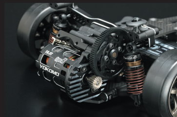
モーター位置を7段階に設定可能とし、路面に合わせたロールバランスを獲得
